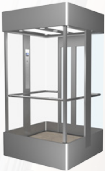
KG01 Cubierta superior e inferior: acero inoxidable satinado Pared panoramica: vidrio templado laminado Techo: acero inoxidable con placa transparente acrilica Pared de la cabina: acero inoxidable satinado Pasamanos: acero inoxidable espejo Piso: PVC
