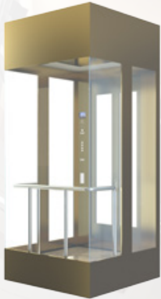
VE07 Cubierta superior e inferior: acero inoxidable espejo PVD dorado Pared panoramica: vidrio templado laminado Pared de la cabina: recubrimiento PVD acero inoxidable espejo dorado, Pasamanos: acero inoxidable espejo Piso: PVC
