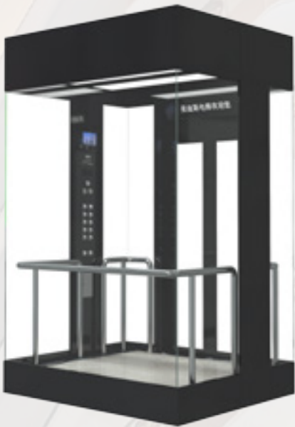
KG07 Cubierta superior e inferior: acero inoxidable satinado PVD negro Pared panoramica: vidrio templado laminado Techo: acero inoxidable espejo PVD negro con placa acrilica transparente Pared de la cabina: acero inoxidable PVD espejo negro Pasamanos: espejo de acero inoxidable Piso: PVC
